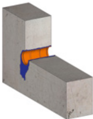
Einbausituation ohne KRASO® Wanddurchführung Typ B
