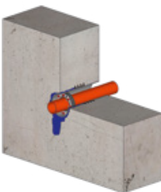
Einbausituation KRASO® Futterrohr Typ FE
