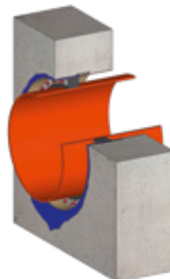
Einbausituation KRASO® Futterrohr Typ FE/MI
