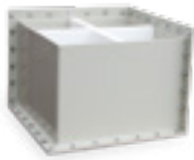
Beispiel 80 x 80 x 60 cm mit angebauten Anpressflanschplatten zur Abdichtung an vorhandener Betonwand, inkl. EPDM Zulage, Bohrlöchern Ø 12 mm zum Ankleben und KRASO® PU 50, zum Ausgleich von Unebenheiten zur Bestandswand
